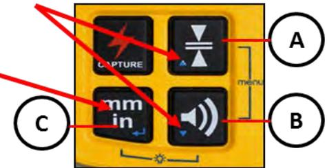
Falls „LS“ noch nicht gewählt ist, die Taste - Masseinheit kurz drücken, danach die Toleranz- oder Tonsignal-Taste drücken bis „LS“ angezeigt wird.
