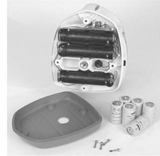
3. Vuelva a colocar el compartimiento de baterías y fíjelo con los cuatro tornillos.
