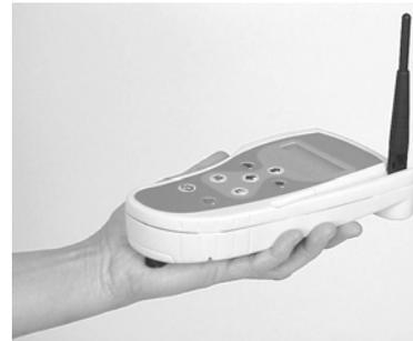
Si conecta el radiocontrol remoto a una mira, y lo está usando en posición vertical, la antena debe sobresalir de la parte superior del radiocontrol remoto.
