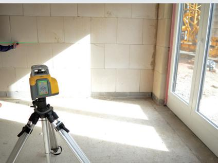
El láser vertical/horizontal HV302G de Spectra Precision® con autonivelación automática ofrece, a un gran precio, una versatilidad excepcional y una mejor visibilidad del rayo verde para aumentar la productividad.
