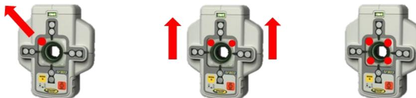
**Line Scan:** Para conseguir una configuración más rápida el segundo día, Line Scan (Escaneo lineal) permite un movimiento totalmente automático del haz de láser hasta los límites izquierdo y derecho.
