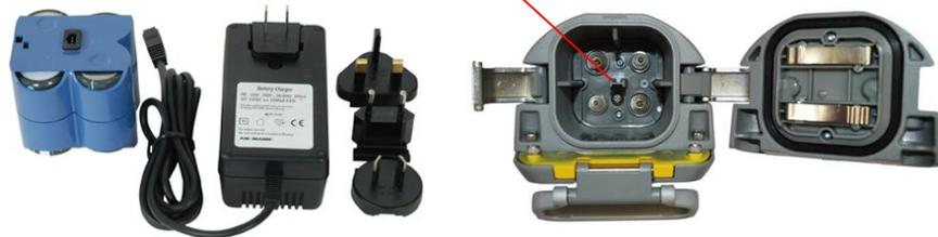
**Las pilas solo se deben cargar cuando el láser esté a entre 10 °C y 40 °C. La recarga a una temperatura más alta podría dañar las pilas. La recarga a una temperatura inferior podría prolongar el tiempo de carga y disminuir la capacidad de carga, lo que supondría una pérdida de rendimiento y una reducción de la vida útil prevista.**
